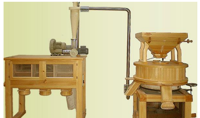
Der grundstzliche Aufbau von Getreidemhlen mit Steinscheiben, wie sie heute verwendet werden, hat sich nicht verndert. Lediglich der Wasserradantrieb findet sich nur mehr bei Schaumhlen. Quelle: Osttiroler Getreidemhle
