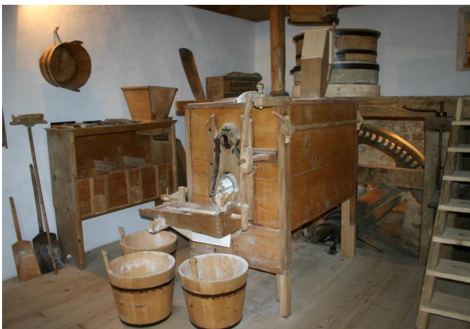
Beispiel einer revitalisierten Getreidemhle mit Wasserrad, Pfaffenlehnermhle. Quelle: J. Wagner
